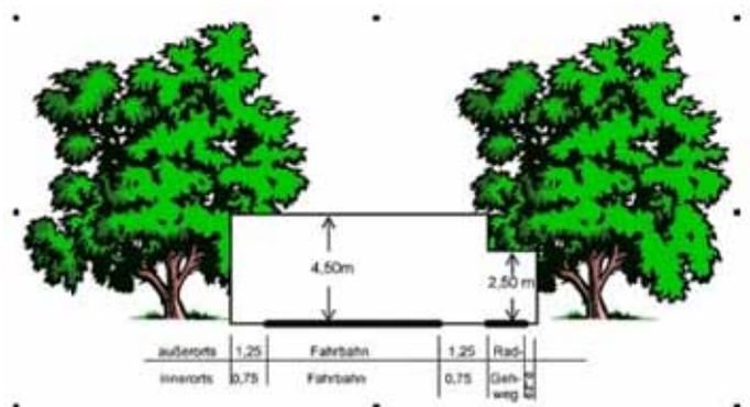
4,50 Meter für den Kraftfahrzeugverkehr über der gesamten Fahrbahn. Der Verkehrsraum ist die befestigte Fahrbahnbreite plus beidseitig mindestens 50 Zentimeter Sicherheitsfläche.
